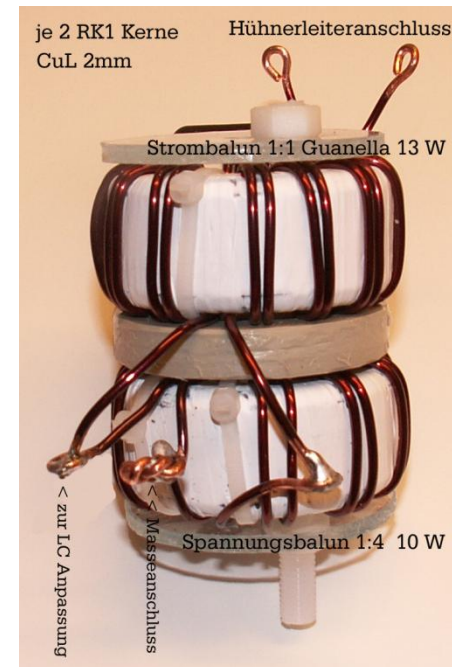
Hybrid-Balun AufbauDF1BT, RK1 oder RK4 Kerne mit Teflonband umwickelt. Vorteilhafter als der Kupferlackdraht wäre teflonisierte Litze.
